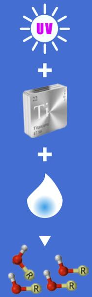
Dentro del reactor se produce una reacción al emitir radiación ultravioleta sobre el Bloque de Titanio ( $TiO_2$ ) con agua, esto produce radicales hidroxilo, quienes se encargan de degradar e inactivar la materia orgánica y los microorganismos patógenos existentes en el agua con una eficacia y velocidad superiores a todos los agentes oxidantes, menos el Flour. Todo sin la necesidad de agregar producto químico alguno. Por eso h2o.Titanium es la mejor opción de Fotocatálisis Oxidativa del Agua.
